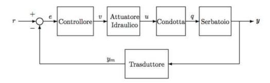
In figura è schematizzato un sistema di controllo del livello di un serbatoio connesso all'attuatore idraulico di comando da una condotta. Il serbatoio e la condotta sono rispettivamente modellati dalle funzioni di trasferimento S(s), fra la portata q in ingresso al serbatoio e il livello y del liquido nel serbatoio, e Q(s), fra la portata u a monte della condotta e la portata q. In appropriate unità di misura, tali funzioni di trasferimento valgono
