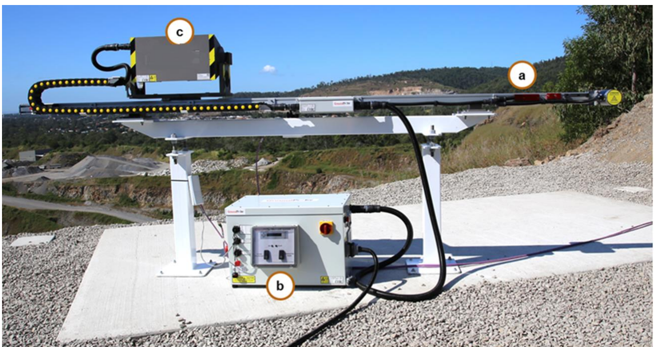
Figura 1: sistema Lisamobile, con indicati i principali componenti: (a) posizionatore lineare, (b) power base e (c) testa di misura.
